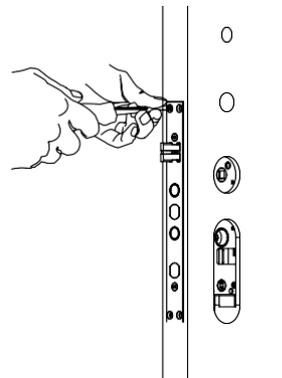
4. 在外面板上裝上連接螺管，並把機械鑰匙撥片裁剪到適合的長度，執手孔中放上壓簧和方軸。
