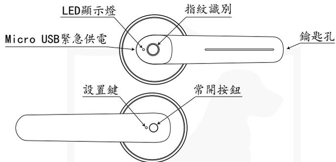
1. Micro USB 緊急電源接口：產品低電壓時可以充電或臨時開鎖
